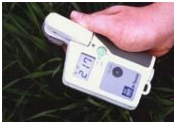
Yara N-Tester kan brukes som hjelpemiddel i 'Grindstad' timotei til å vurdere behovet for nitrogen ved delgjødsling i midten av mai (ved beg. strekningsvekst). Foto: Yara.
